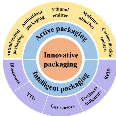
Figura 4.2. Classificazione dei sistemi innovativi di confezionamento alimentare. (TTI: indicatori tempo-temperatura; RFID: identificazione a radiofrequenza) (Jinsong., J. Feng, 2022)
