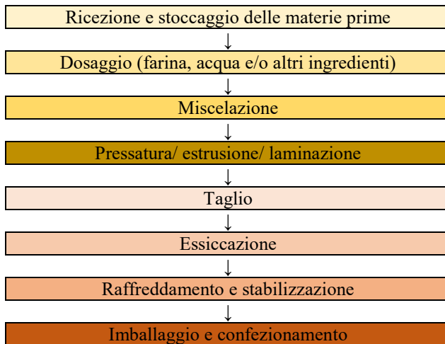
Figura 6.1. Schema tecnologico generale della produzione di pasta (da Klinger 2010)
